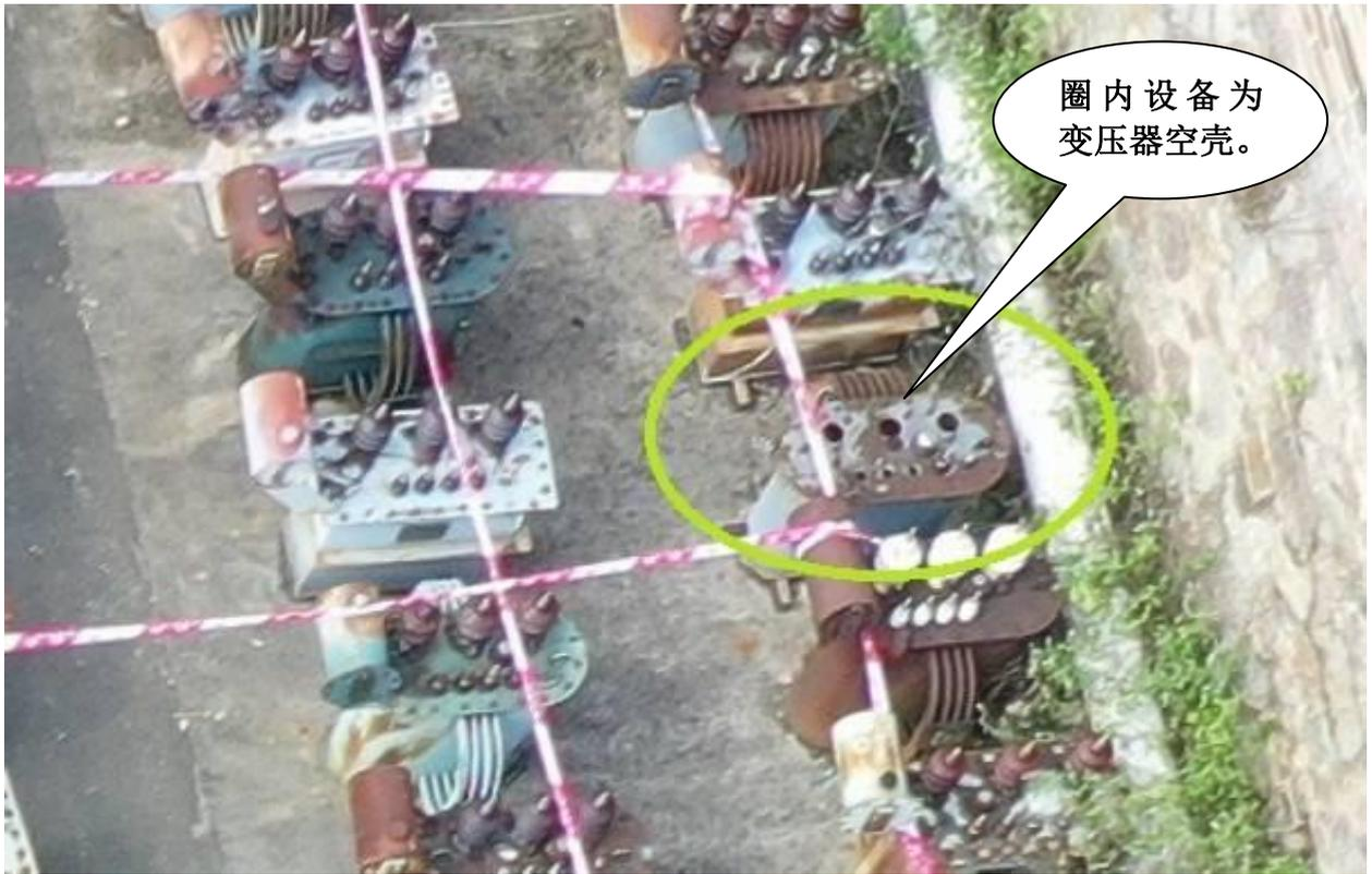
钦州供电局：报废变压器及变压器空壳-9（西塘变电站仓库）局部视角
