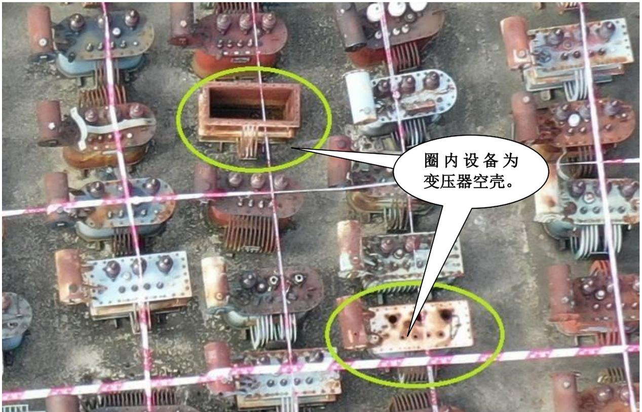
钦州供电局：报废变压器及变压器空壳-8（西塘变电站仓库）局部视角
