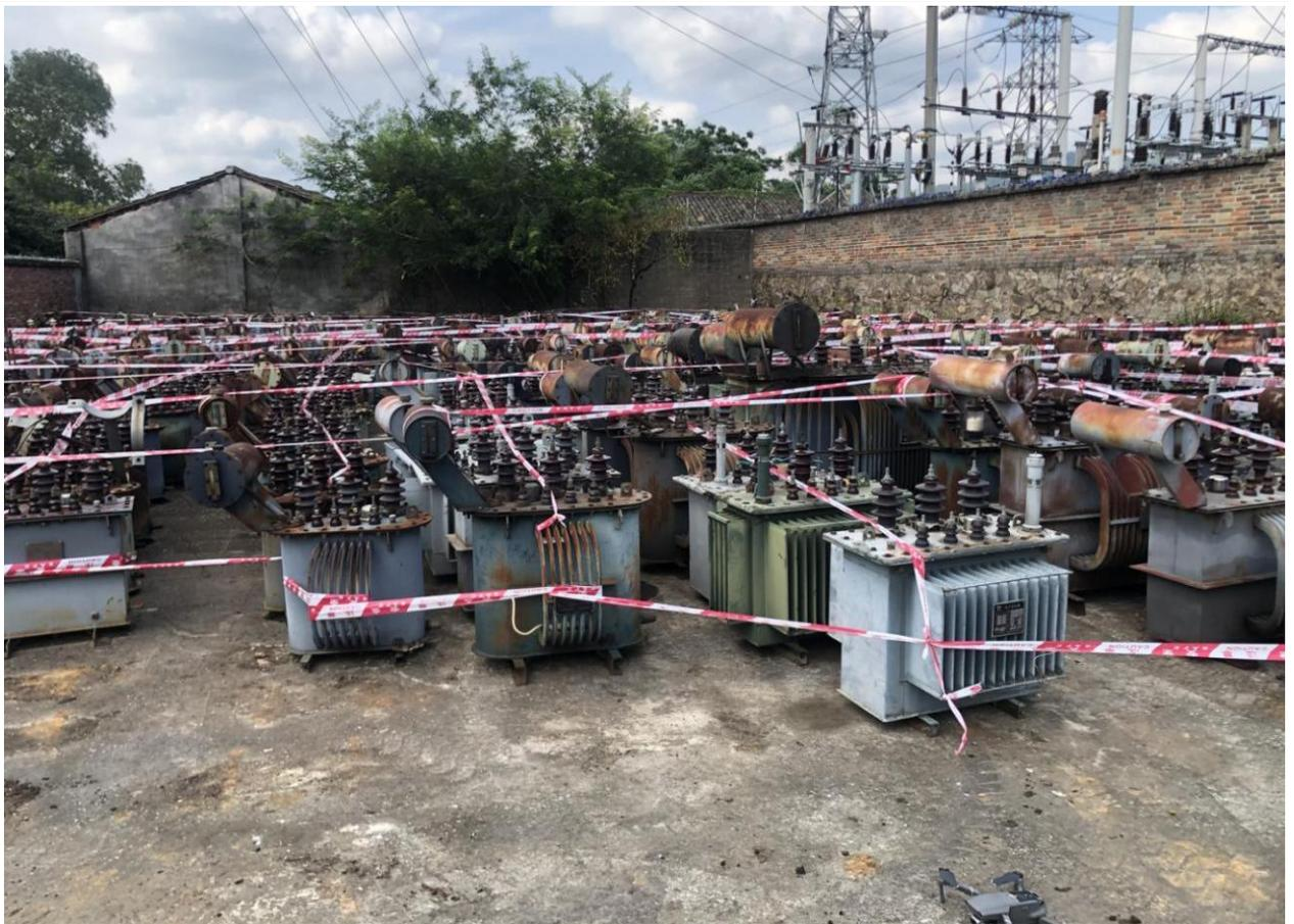
钦州供电局：报废变压器及变压器空壳-6（西塘变电站仓库）局部视角
